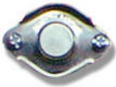
Los puestos de control se basan en dispositivos llamados Touch Memories, los cuales poseen un Nro. de serie interno único que permite identificar cada puesto en forma inequívoca. Cada una de estas "pastillas electrónicas" posee, en encapsulado metálico de alta resistencia, un micro-chip con un número de código único e irrepetible (ID), lo que las hace altamente resistentes y les permite funcionar, incluso al intemperie. Además, no requieren ningún cableado ni mantenimiento.
